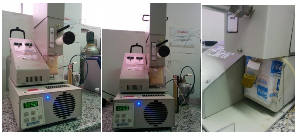
Figura 6. Unidade de Extração Supercrítica. Equipamento Piloto utilizado neste trabalho, STF-110.
