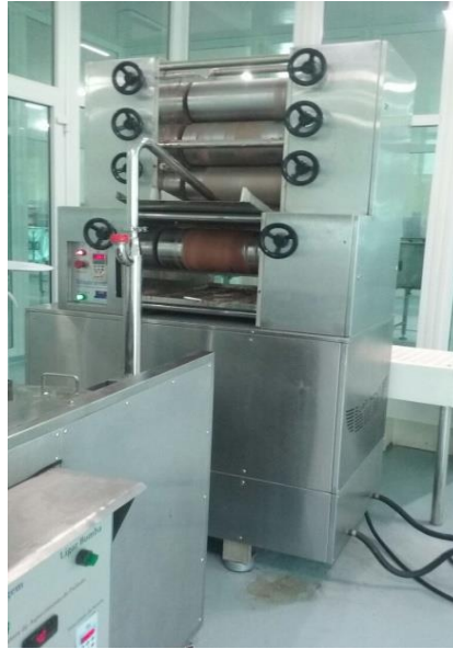
Figura 8. Moinho de rolos. (Imagem concedida pela fábrica Mendoá, Ilhéus – BA).
