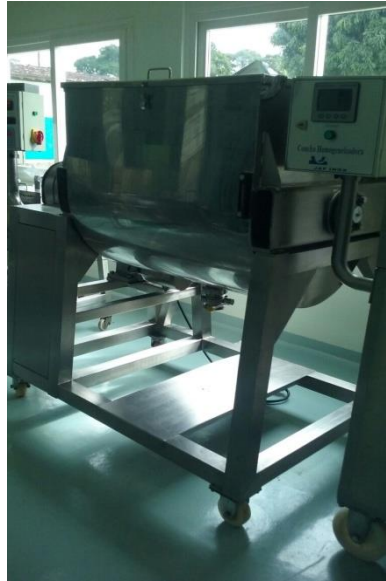
Figura 9. Equipamento para conchagem. (Imagem concedida pela fábrica Mendóá, Ilhéus – BA).
