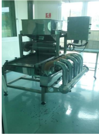
Figura 6. Equipamento para separação do nibs de cacau da casca. (Imagem concedida pela fábrica Mendoá, Ilhéus – BA).
